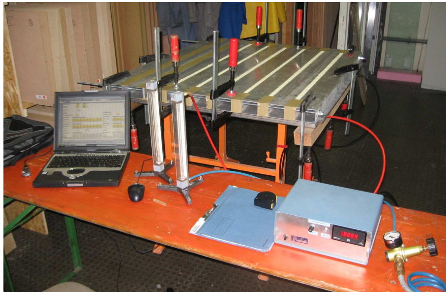
Abbildung 2 Messeinrichtung mit Durchfluss- und Druckmesseinheit.
