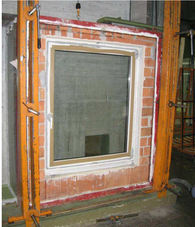
Bild 1 Probekörper aufgebaut auf dem Fensterprüfstand
